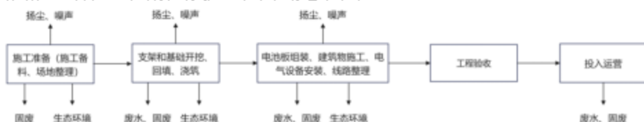
图 4.1-1 施工工艺流程和产排污节点图
