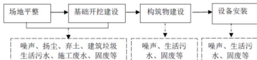
图 2.4-2 升压站施工过程示意图
